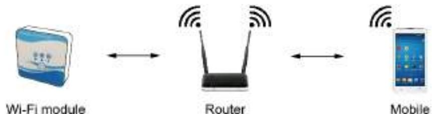
Encienda la bomba de piscina y los indicadores de funcionamiento y de comunicación del módulo Wi-Fi se iluminarán. Pulse el botón de configuración durante 3 segundos. Cuando el indicador de Wi-Fi continúe parpadeando, pulse 'Confirm indicator rapidly blink' (Confirmar que el indicador parpadea rápidamente).
